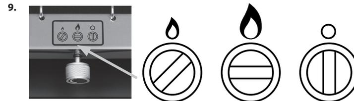
Om de vlam lager te zetten, draait u de regelknop naar de kleine vlam. Om de vlam hoger te zetten, draait u de regelknop naar de grote vlam. Om het apparaat uit te zetten, draait u de regelknop naar OFF.
