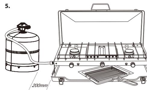
Tilslut regulatoren til en passende gasflaske i overensstemmelse med national lovgivning og standarder. Spørg din LPG-forhandler til råds.
