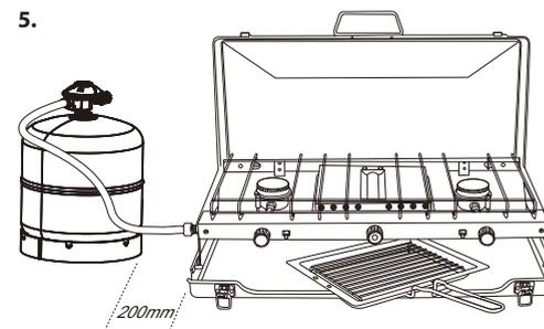
5. Fest regulatoren til en passende gassylinder i samsvar med nasjonal lovgivning og standarder. Spørg LPG-forhandleren din om råd.
