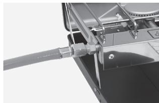
c. Hvis slangen har en 1/4" venstresyning, gøres slangen direkte fast på gasindgangen (4).
