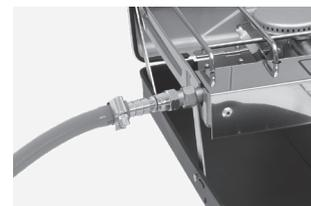
a. Si votre flexible présente un diamètre interne de 8 mm, poussez le flexible sur la première moitié rainurée de l'embout amovible. Enfilez le flexible et l'embout sur la connexion de l'alimentation en gaz (4).
