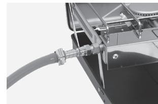
a. Wenn Ihr Schlauch einen Innendurchmesser von 8 mm hat, schieben Sie den Schlauch über die erste gerippte Hälfte des abnehmbaren Anschlussstutzens. Schieben Sie den Schlauch und den Anschlussstutzen auf den Gaseinfüllstutzen (4).
