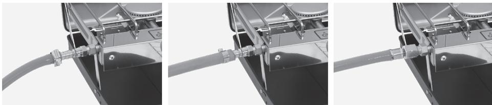
a. Hvis din slange har en innvendig diameter på 8 mm, skyv slangen over den første ribbede halvdel av den avtakbare slangenippelen. Gjenge slangen og nippelen inn på gasstilkoblingen (4).
