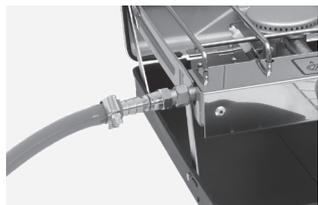
a. Hvis slangen har en intern diameter på 8 mm, skubbes den over den første ribhalvdel af den aftagelige slangetylle. Stik slange og tylle ind i gasindgangen (4).
