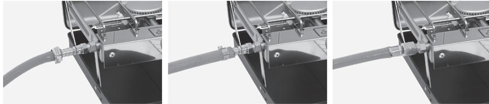
a. Als uw slang een binnendiameter van 8 mm heeft, duwt u de slang over de eerste geribbelde helft van de verwijderbare slangpilaar. Schroef de slang en de slangpilaar op de gasinlaataansluiting (4).
